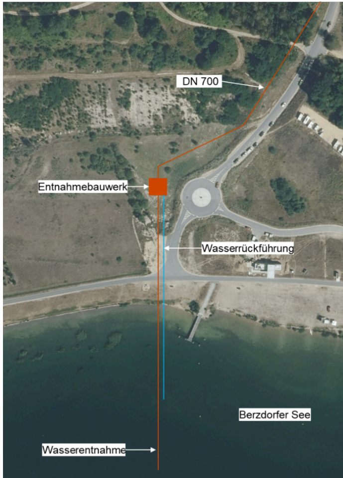
Abbildung 16: Geplanter Aufbau der Wasserentnahme für die Seewasser-Wärmepumpe.
